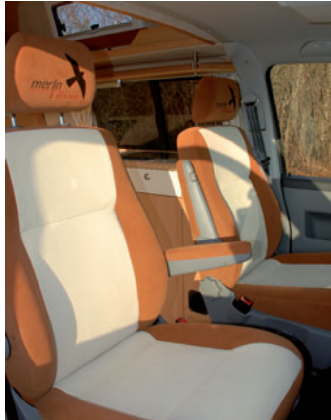
Fahrer- und Beifahrersitz sind höhenverstellbar und mit Lendenwirbelstütze und Armlehnen ausgestattet. Der Beifahrer-Sitz kann darüber hinaus nach hinten in den Wohnbereich gedreht werden.
